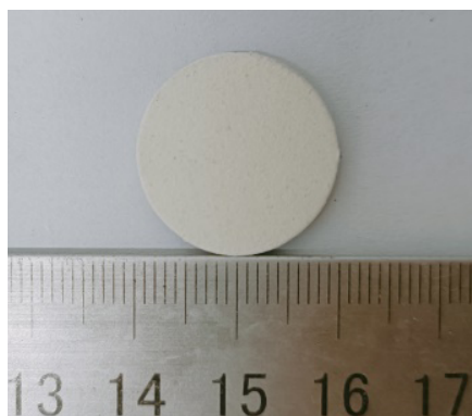
图 2 APS 制备的 GYbZ/8YSZ 涂层样品
